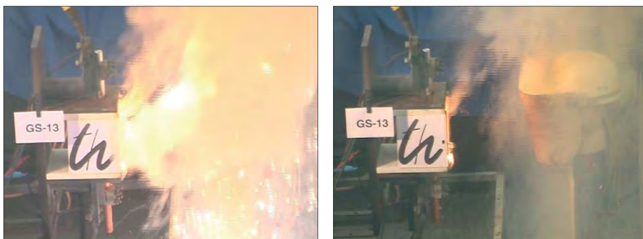
Bild 1: Störlichtbogenprüfung im Box-Test des Elektriker-Gesichtsschutz BSD ErgoS
